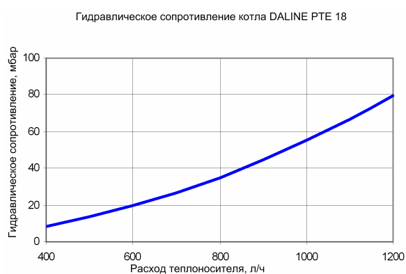
Рис.16. Гидравл. потери котла «Daline PTE 4-18»
